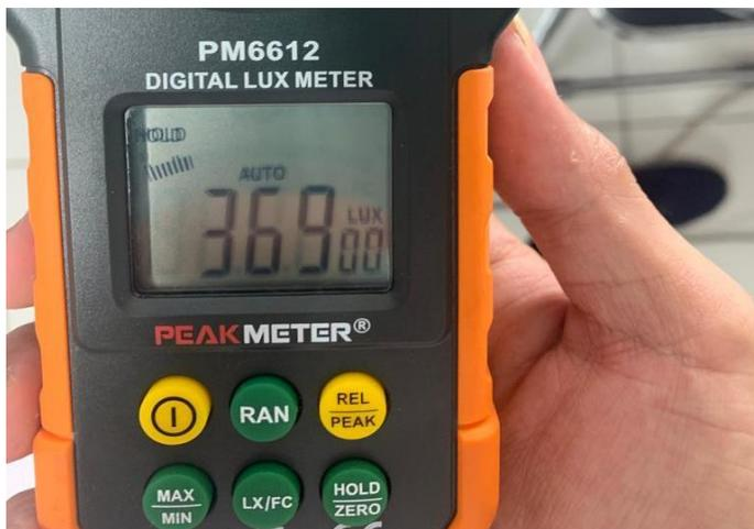
Gambar 17 Hasil Pengukuran cahaya dengan duty cycle 90%
